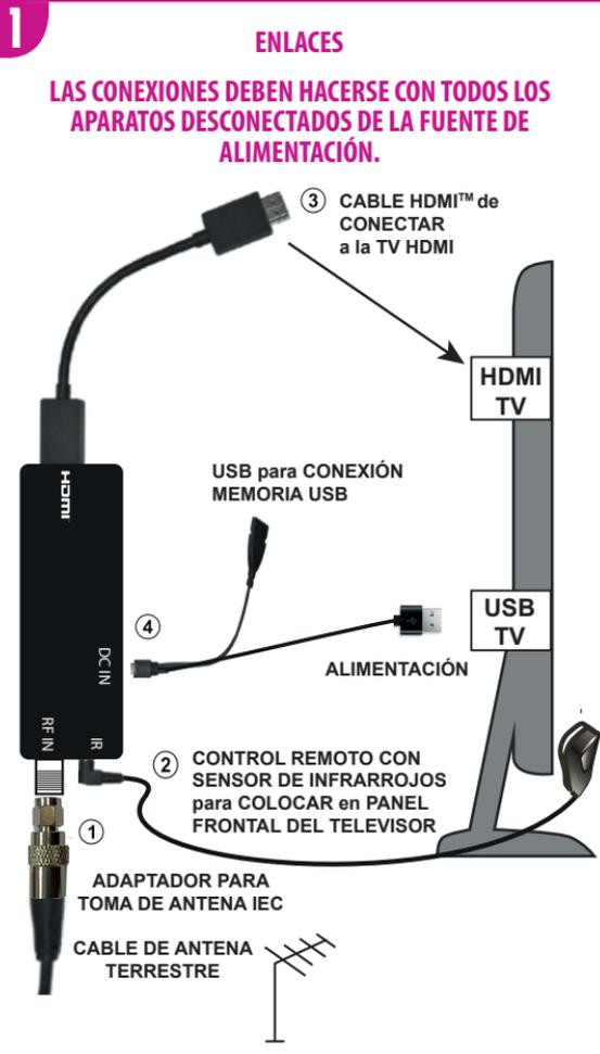
1- Atornille el adaptador de enchufe Antena IEC incluida en el paquete a la toma de antena RF IN. Conecte el cable de la antena con el adaptador de toma de antena IEC.
