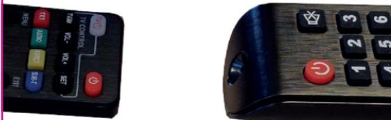
En el control remoto del televisor, mantenga presionado el botón que desea configurar (por ejemplo, VOL+) siempre que el LED rojo permanezca fijo. Presione el botón SET para guardar. Establezca una tecla a la vez. Para otros consulte el manual.
