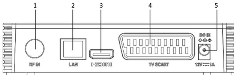
1. **RF IN** per il collegamento della antenna.
