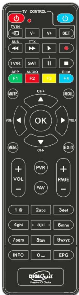
**TTX/▶▶**: per aprire il televideo. Quando si riproduce un file: per andare avanti alla velocità di 2X, 4X, 8X, 16X e 32X.
